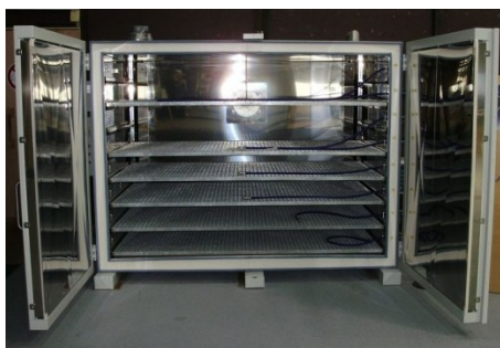
Figure 8 : Cuisson des modules en étuve industrielle (8 clayettes de 2m 2 )
