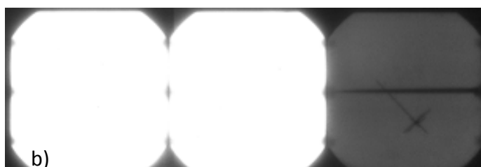
Figure 9: Test en électroluminescence: a) bonne continuité des 3 cellules - b) endommagement de la cellule droite
