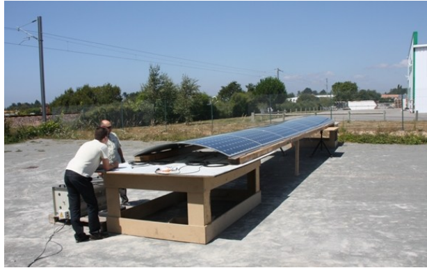
Figure 12 : Essais de régulation de la toiture du train "Rayon Vert" avec prise en compte des ombrages dynamiques
