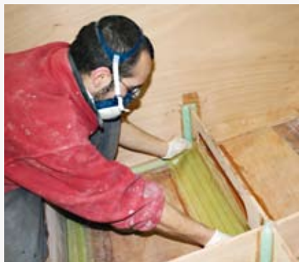
Gaël pose ensuite la bande sur le joint, pour une liaison encore plus robuste.
