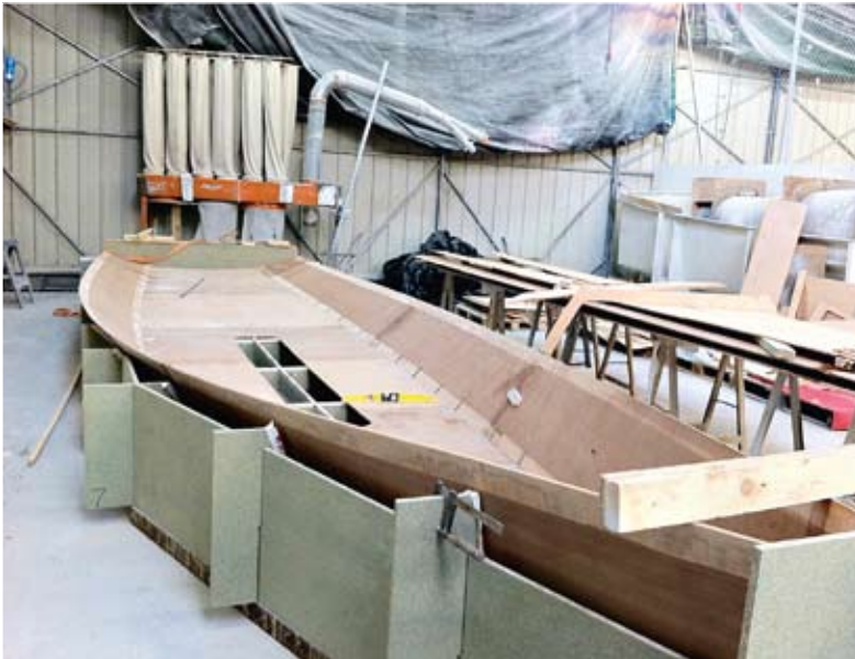
Sole et bouchain sont agrafés pour guider la forme de la carène du bateau. On voit également à l'arrière un gabarit mâle sanglé à la forme.
