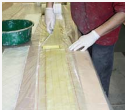
Imprégnation en résine de la bande de tissu bi-biais destinée au corniéragé.
