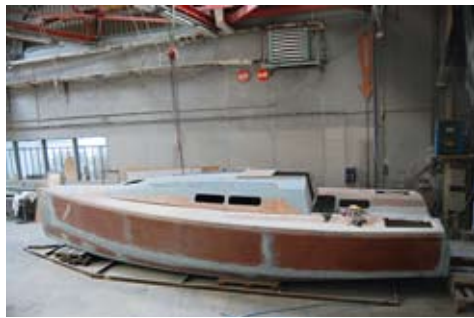
Le pont est désormais collé, il ne reste plus qu'à stratifier sur et sous le pont.
