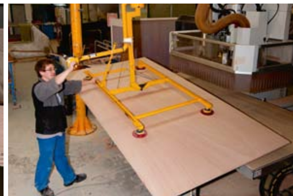
L'opérateur utilise la grue à ventouses pour déplacer le panneau sous la machine.
