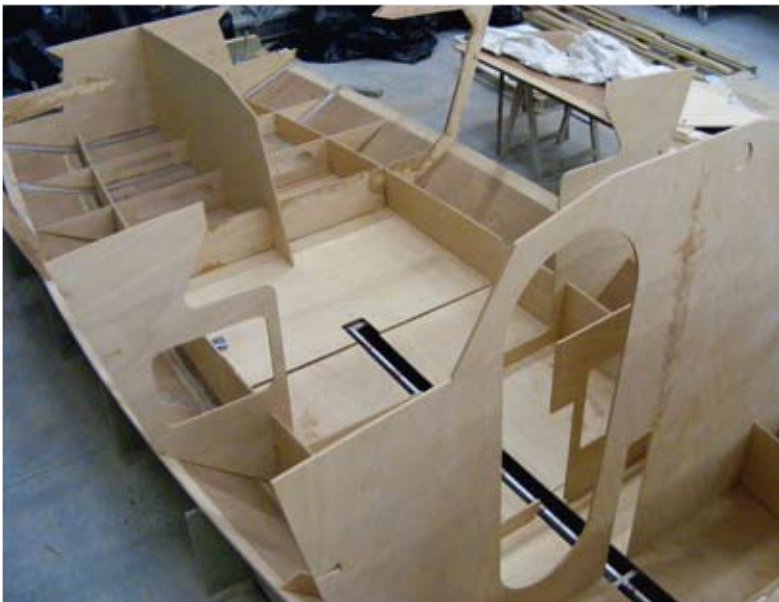
Une fois la forme et le bouchain définitifs, le chantier a posé à blanc (c'est-à-dire pour de faux) les cloisons structurales pour contrôler l'imbrication.
