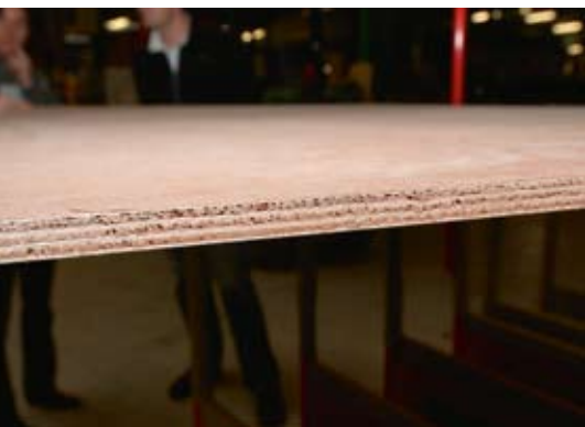
Le panneau de CP brut du bateau avec une face moabi et âme en okoumé.
