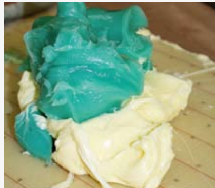
Résine chargée et catalyseur (en jaune) vont constituer le joint proprement dit.
